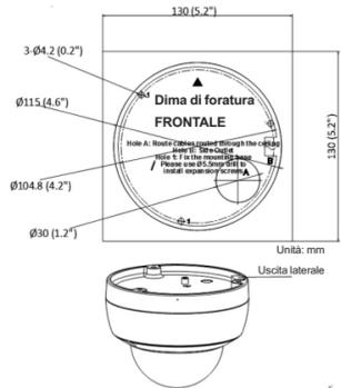
3. Montare i cavi e fissare la base di montaggio al soffitto con tre viti.
